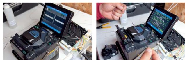
Die beiden Kabel werden automatisch eingerichtet und mittels Lichtbogen verschweißt.
