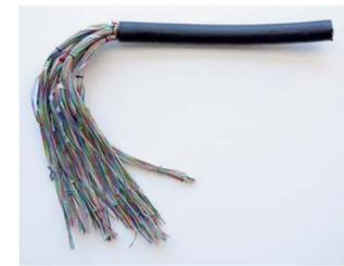
Herkömmliche Kupferkabel mit einem Adern-durchmesser von 0,6 mm machten eine Datenübertragung bis maximal 0,03 Gigabyte möglich.
